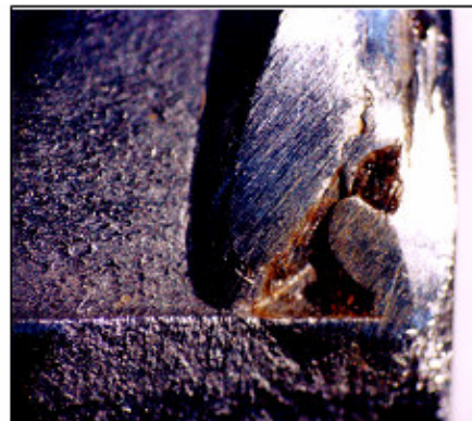
Figura 16. Barra de acero inoxidable 316 después de la polarización cíclica en solución de agua de poro al 0.5% de cloruro de sodio. (Vista: lupa estereoscópica).
