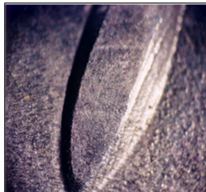
Figura 14. Barra de acero inoxidable 316 después de la polarización cíclica en solución de agua de poro al 0% de cloruro de sodio. (Vista: lupa estereoscópica).
