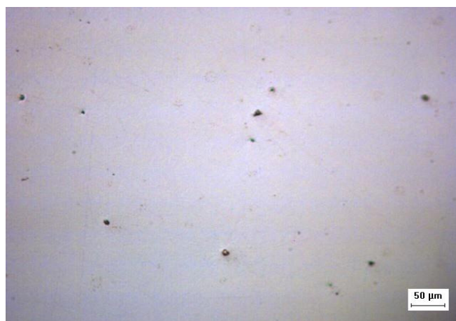
Figura 6. Imagen óptica de las picaduras formadas sobre la muestra de la aleación \text{Al}_{90}\text{Fe}_7\text{Zr}_3 (barra).
